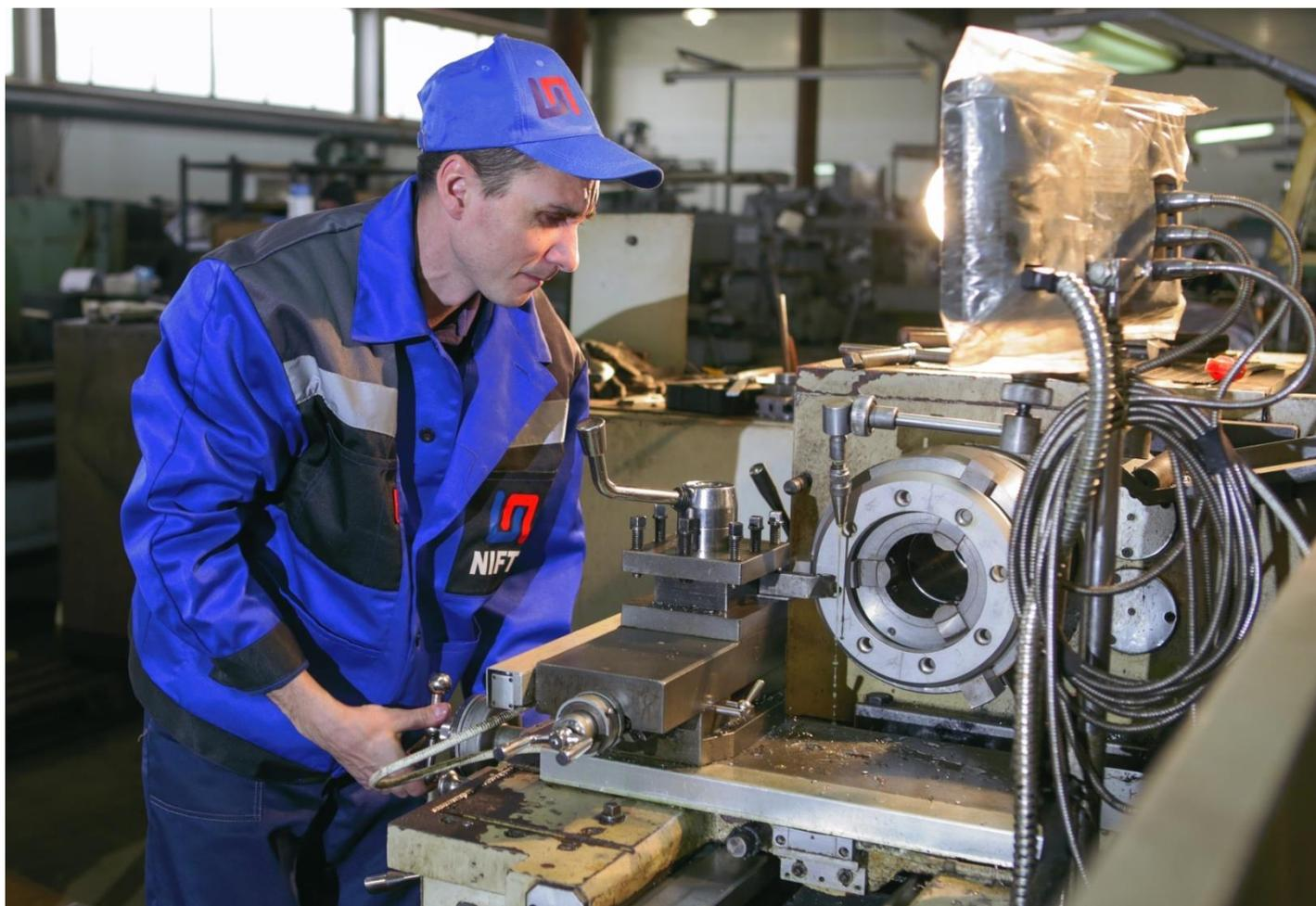
Токарно-винторезный станок GH-1880 с УЦИ предназначен для выполнения всевозможных (черновых и финишных) видов токарной обработки деталей тел вращения, включая производительное нарезание метрической, дюймовой, модульной и питчевой резьб.
